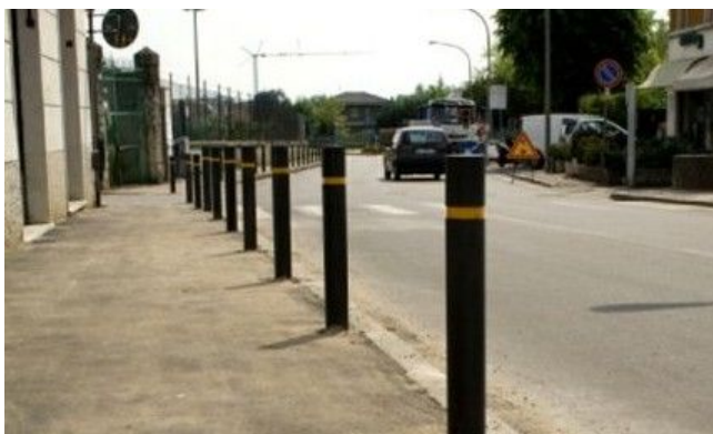
Figura 304 Esempi di dissuasori della sosta: paletti, archetti, fioriere e panettoni.
