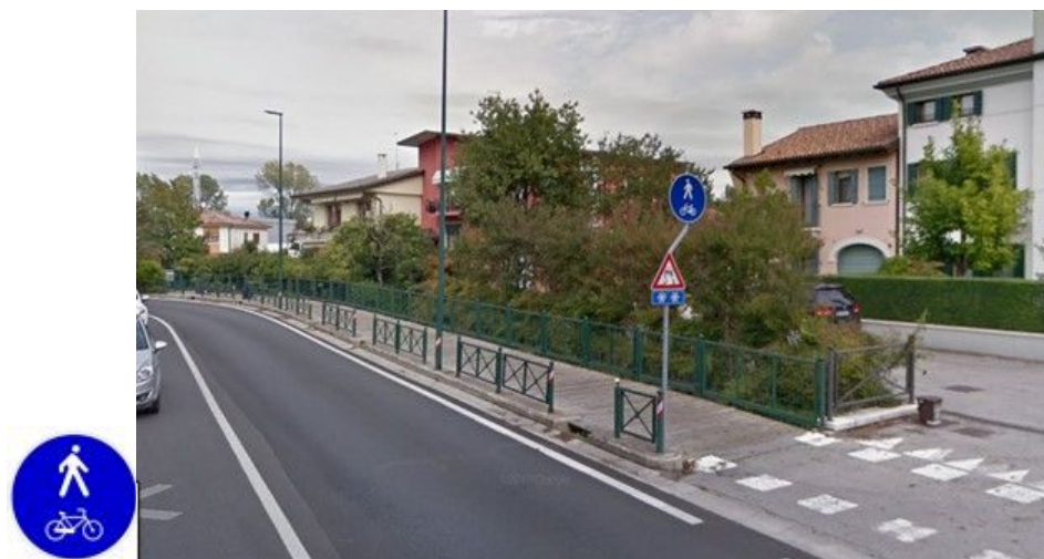
Figura 342 Segnaletica verticale ed esempio di percorso ciclopeditonale
