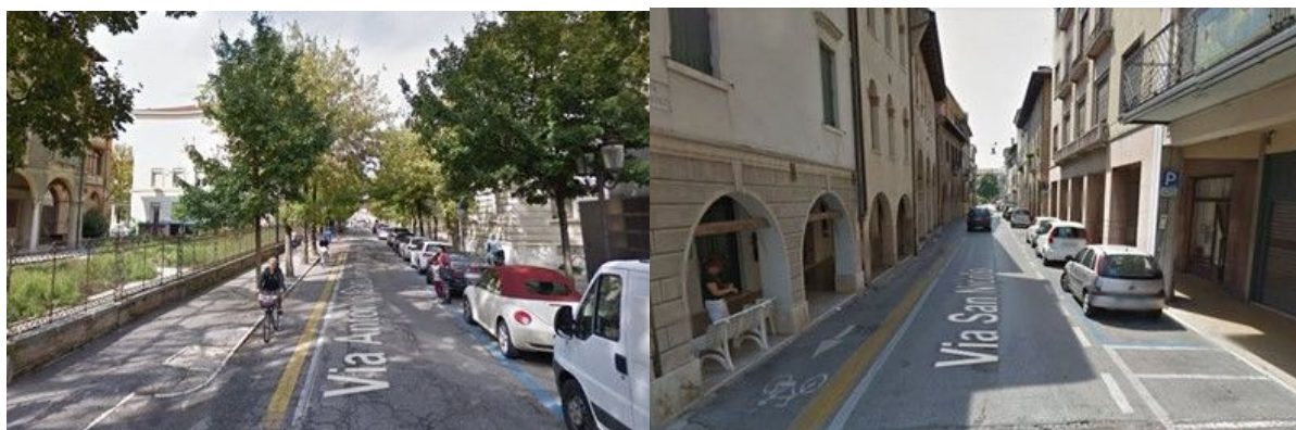
Figura 337 Esempi di pista ciclabile con corsia riservata in direzione opposta a quella degli altri veicoli
