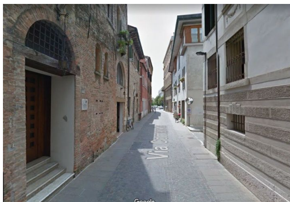
Figura 325 Esempio di utilizzo della pavimentazione differenziata all'interno di ZTL per accennare gli spazi pedonali in assenza di segnaletica
