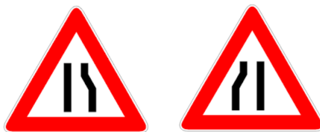
Figura 312 Segnaletica verticale per le chicane
