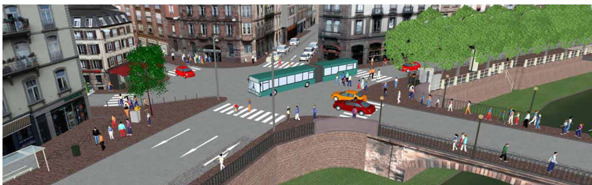
Figura 11. Esempio di visualizzazione 3D di un modello di rete in PTV VISSIM
